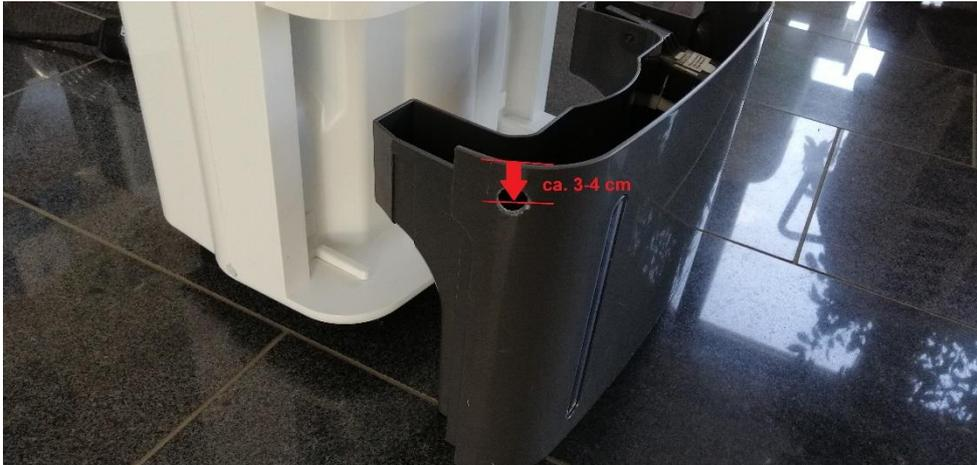
Bohren Sie ein Loch (mind.  $\varnothing$  14 mm) an der linken oberen Seite des Wasserbehälters, ca. 3-4 cm unterhalb des Randes.
