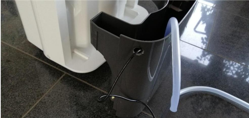
Kondenspumpe mit Schlauch in den Wassertank einsetzen
